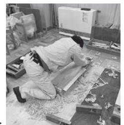
教卓外板のカナ掛け風景▶ 教卓「前板」のカナ掛け作業も真剣そのものです。
